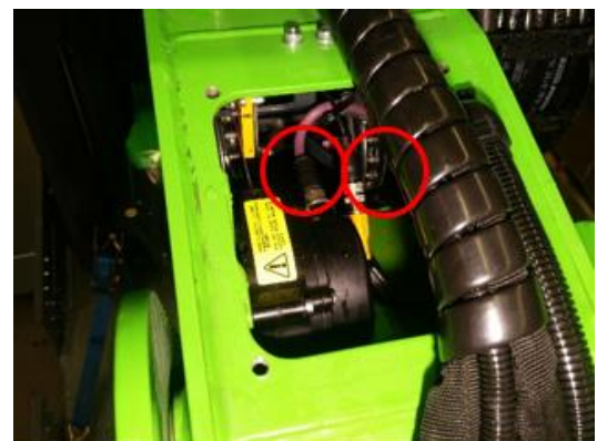
Figur 17: Bladjedetrinsens smørepunkter på forsiden av den øvre bommen.
