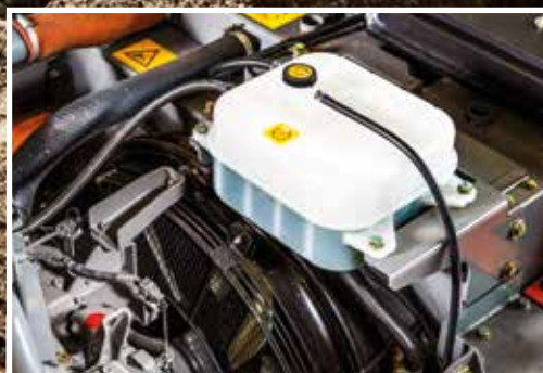
Ekspanjonstanken forhindrer at motordeler overoppheles.
