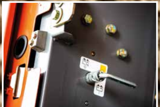
Hovedstrømbryteren gjør vedlikeholdsarbeidet sikrere.
