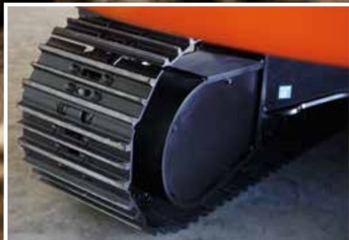
Et forsterket motordeksel reduserer faren for skader.
