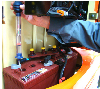
Figur 5-8. Måling av elektrolyttens spesifikke gravitet
