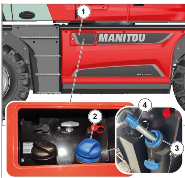
Figur 226: Kontrollere og rengjøre dieseleksosvæsketankfilteret
