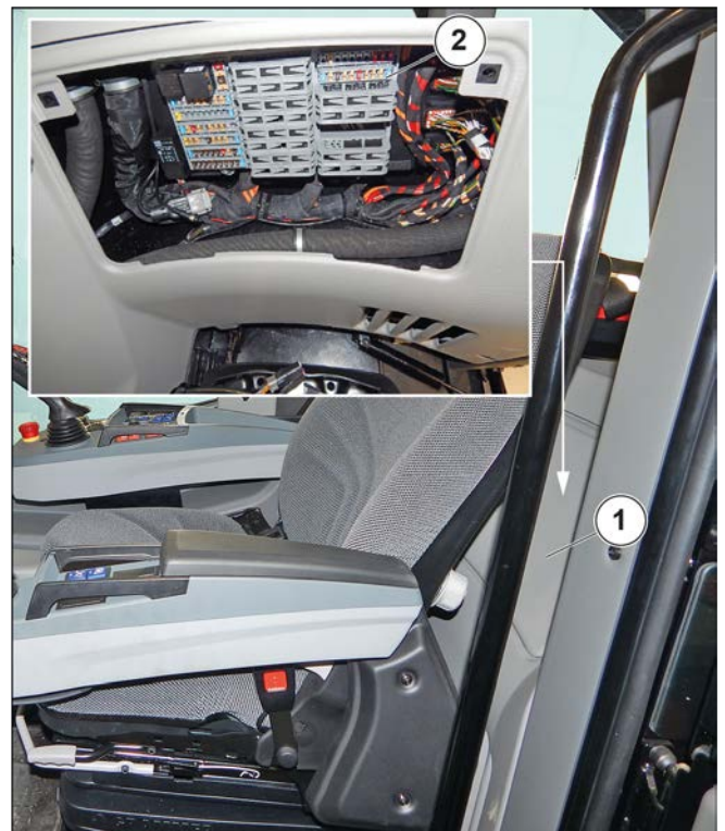
Figur 214: Sikring og relé i førerhus
