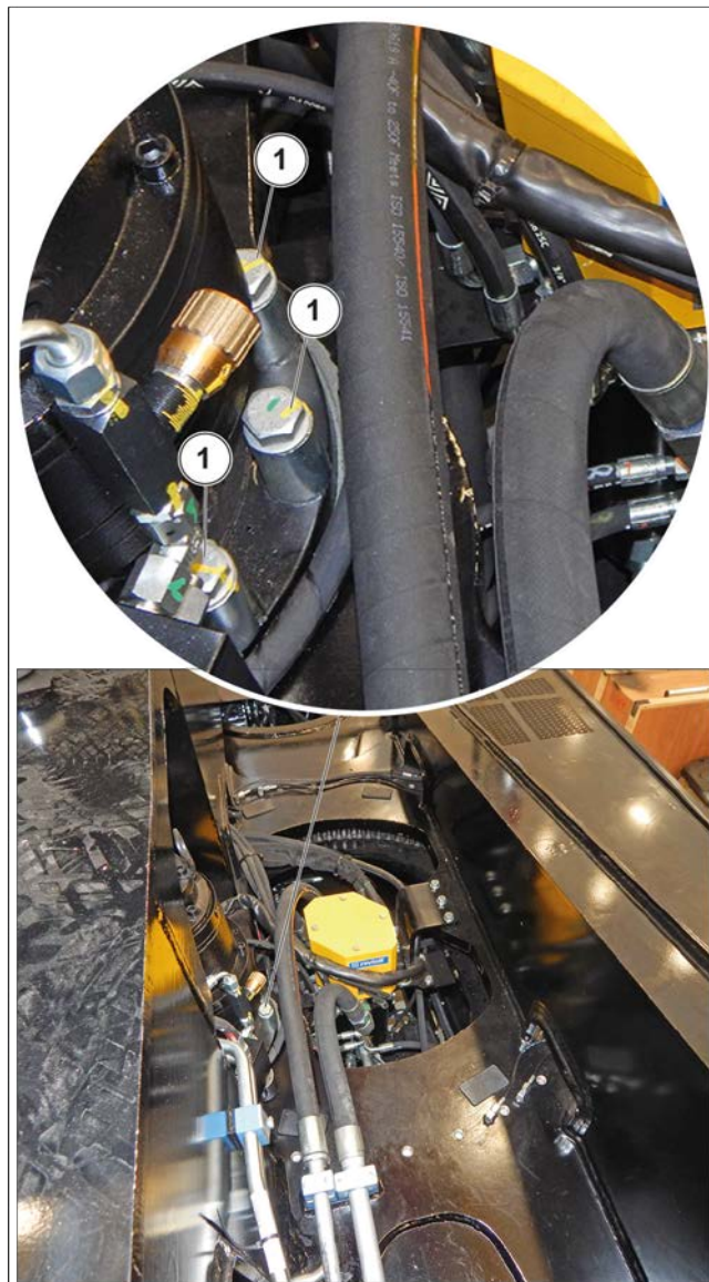
Figur 166: Rotasjonsreduksjonsgirets tiltrekkingsskrue, kontroll
