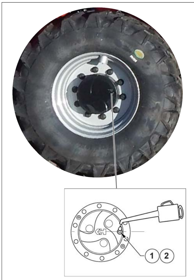
Figur 162: Fremre og bakre hjul reduksjonsgir oljenivåkontroll
