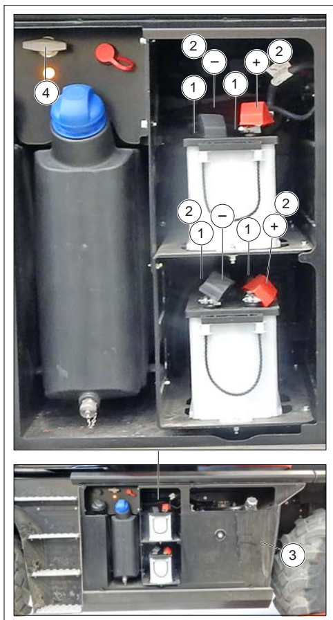
Figur 165: Kontroll av batteri
