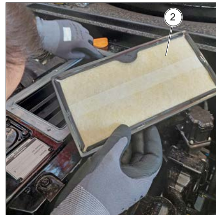
Figur 209: Utskifting av veivhusfilteret for motorens lufteør
