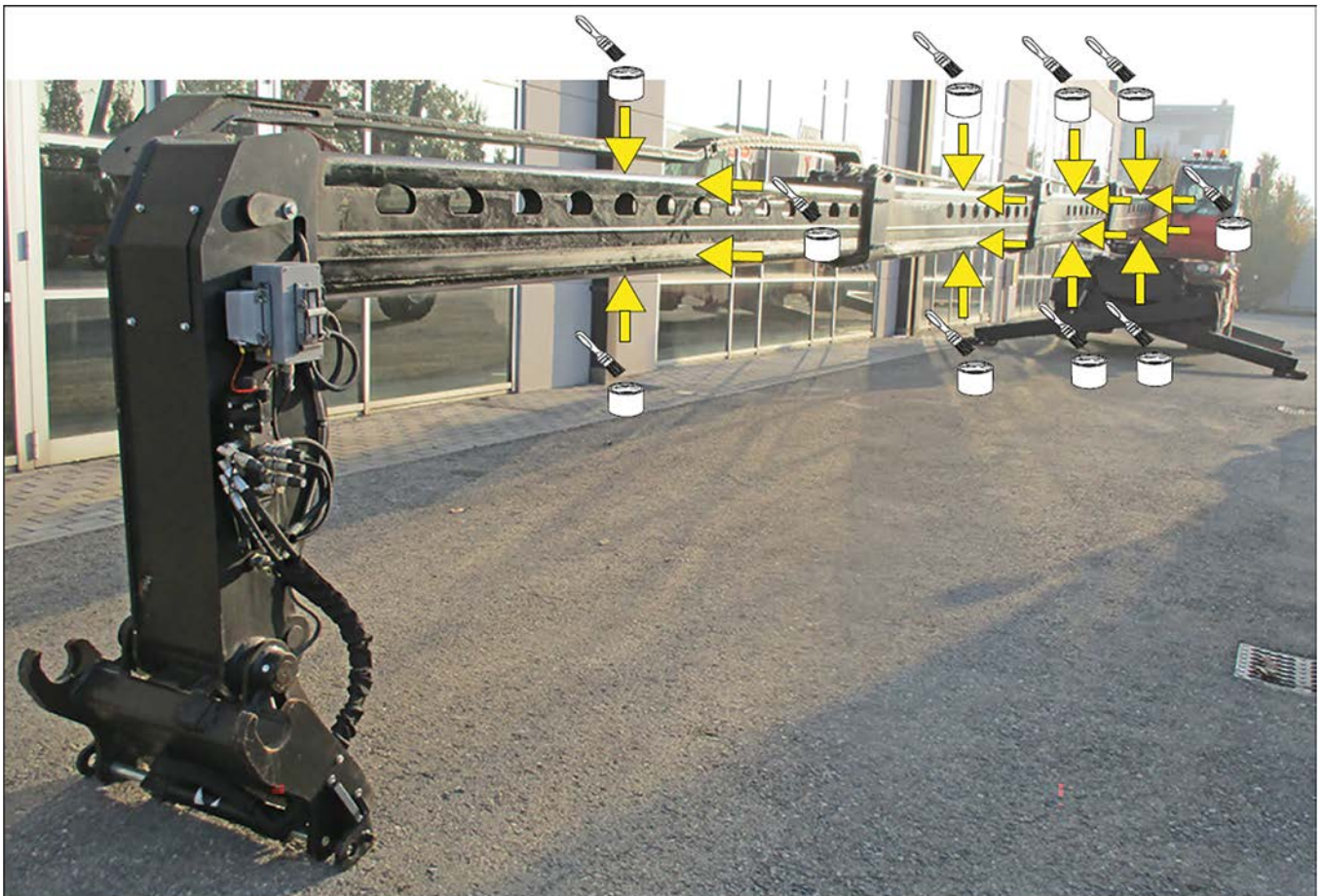
Figur 156: Rengjøring og smøring av teleskopbommens slitesko
