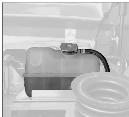
Fig. 310: Ekspansjonstank for kjølemiddel
