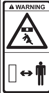
12 ADVARSEL Ikke stå i nærheten av løftet last. (dekal på begge sider av bommen)
