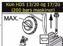
3 Kjemi Ta opp suge slange til kjemi fra kanne. Sett mengdejustering til kjemi på max.
