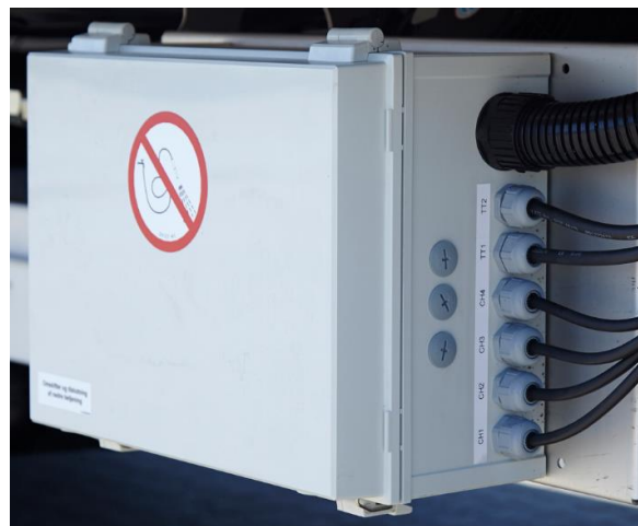
Strømskap under chassis Fig. 4-5-1-A
