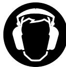
El ruido de la herramienta motorizada puede dañar los oídos. Siempre use amortiguadores del ruido (tapones u orejeras) para protegerse los oídos. Los usuarios constantes y regulares deben someterse con frecuencia a un examen o control auditivo.
