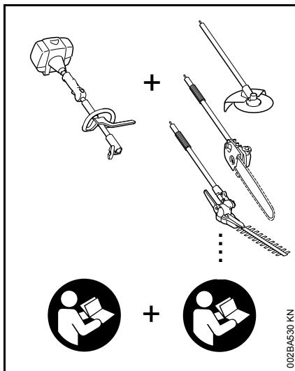
Con el sistema KombiSystem de STIHL, varios motores KombiEngine y accesorios KombiTool pueden combinarse para formar una herramienta motorizada. En este manual de instrucciones la unidad formada por el motor KombiEngine y la herramienta KombiTool se identifica como la herramienta motorizada.
